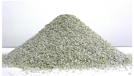
En effet, la cuve de traitement secondaire est remplie d'un lit filtrant<sup>3</sup> développé par WATERCYCLE (mélange de roches volcaniques) dont les propriétés favorisent l'adsorption des métaux lourds et des phosphates.
