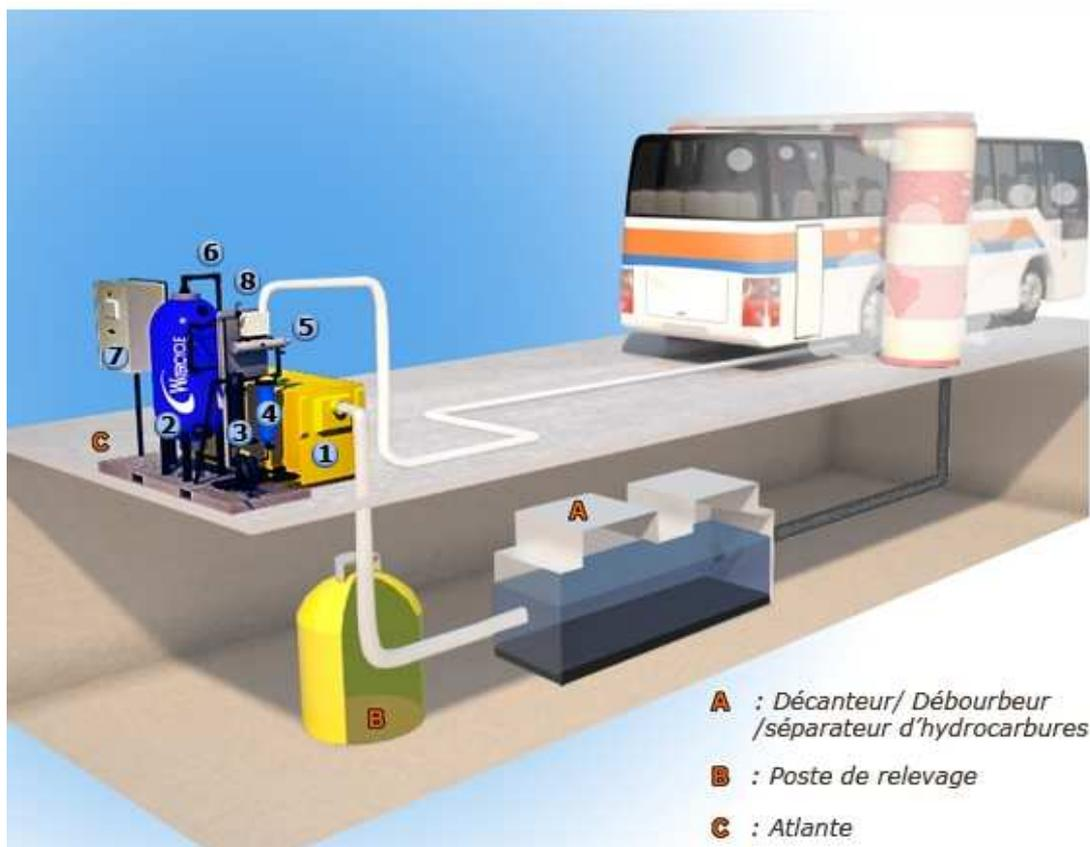
*Schéma de principe de l'installation*
